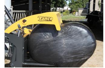
2. Schließen Sie den Rahmen mit dem hydraulischen Steuerhebel über dem Ballen, während sich gleichzeitig der Greifer schließt und die Kunststoffhülle festhält.
