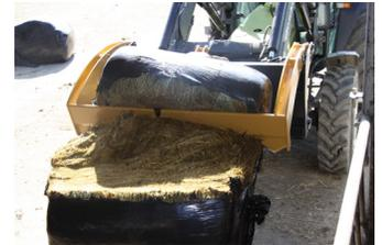
4. Den Rundballenteiler fast vollständig mit den Steuerhebeln öffnen und den Lader gleichzeitig anheben, um die Ballenhälften auf die Futterbahn oder in den Futterwagen zu entladen.
