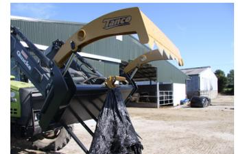
Achten Sie darauf, dass der Rundballenteiler stets vollständig geschlossen ist, wenn Sie ihn nicht gebrauchen. Drehpunkte sollten mithilfe der Schmiernippel regelmäßig geschmiert werden.
