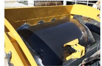
3. Transportieren Sie den Ballen zu der Stelle, wo er zerschnitten werden soll, und schließen Sie den Ballenschneider mit dem hydraulischen Steuerhebel, um den Ballen durch die Kunststoffhülle in der Mitte durchzuschneiden.
